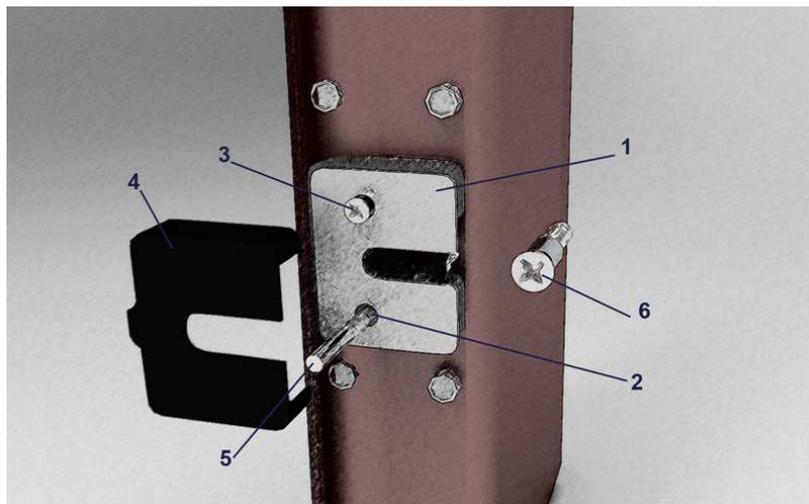
Замена наружной части замка производится без разборки двери. Чтобы внутренняя часть замка не упала внутрь двери. Необходимо открутить удерживающий винт (2), а вместо него вкрутить шпильку (5) длиной 70-80мм либо болт М8 с отрезанной головкой. Затем взять бесшумный замок. Снять с него пластиковый кожух (4) и на место старого замка поставить – бесшумный(1). Завернуть винт (3), Выкрутить шпильку(5) и вкрутить винт (2). Одеть кожух (4).
